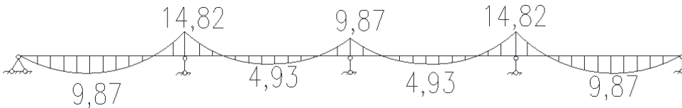
Рис. 4. Эпо́ра изгибающих моментов в неразрезной балке от действия временной нагрузки
