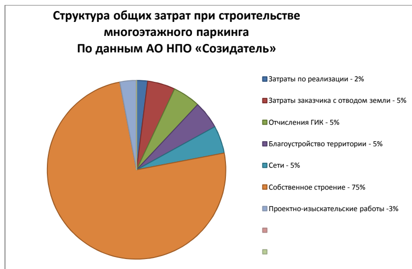
Рис. 3. Структура общих затрат при строительстве многоэтажного паркинга
