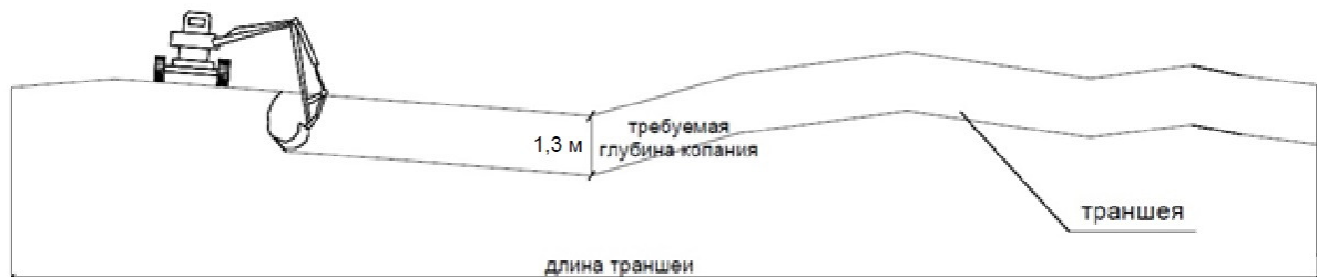
Рис. 8. Схема разработки траншеи предлагаемым вариантом
