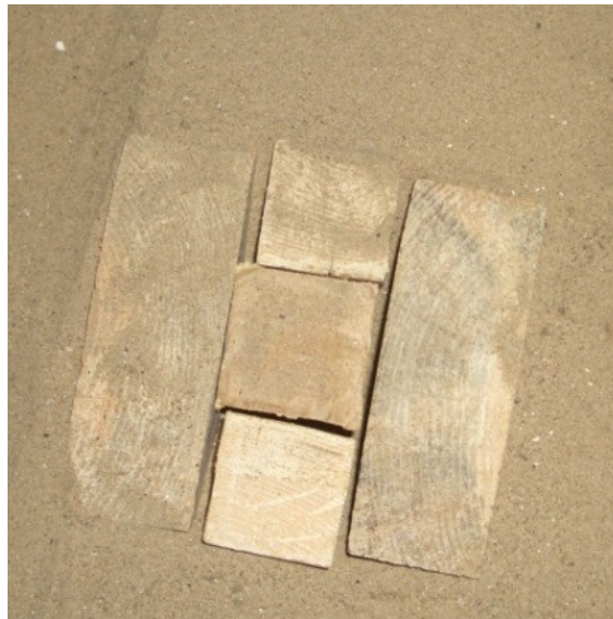
a б Рис. 4. Испытание сваи с клиньями в лабораторных условиях: а) этап нагружения; б) сечение сваи с клиньями
