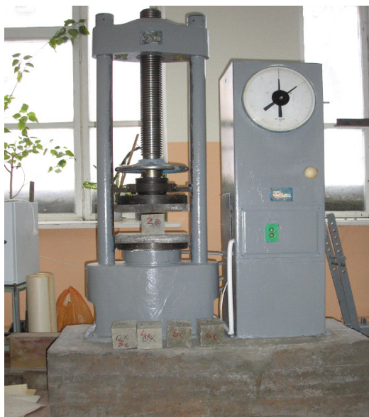
Рис. 1. Испытание кубиков на прессе П-50
